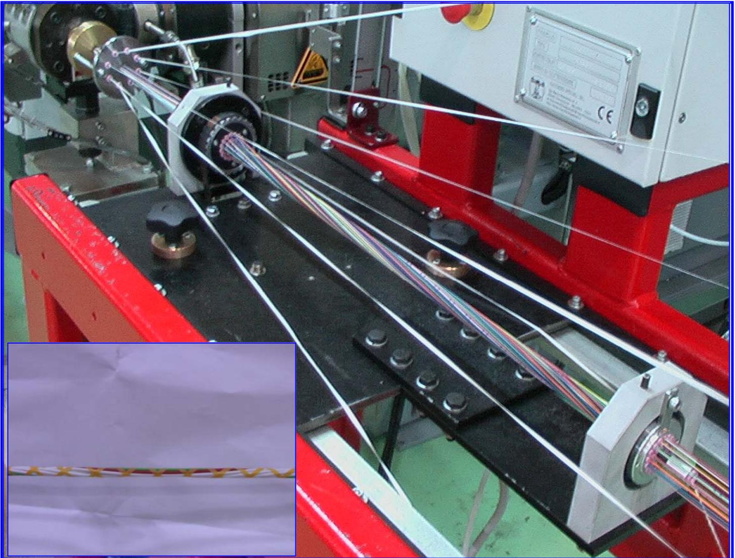
**Linea adatta alla riunitura a passi alternati S-Z di microcavi, composti da fibre ottiche con isolamento tight o conduttori tradizionali.**
